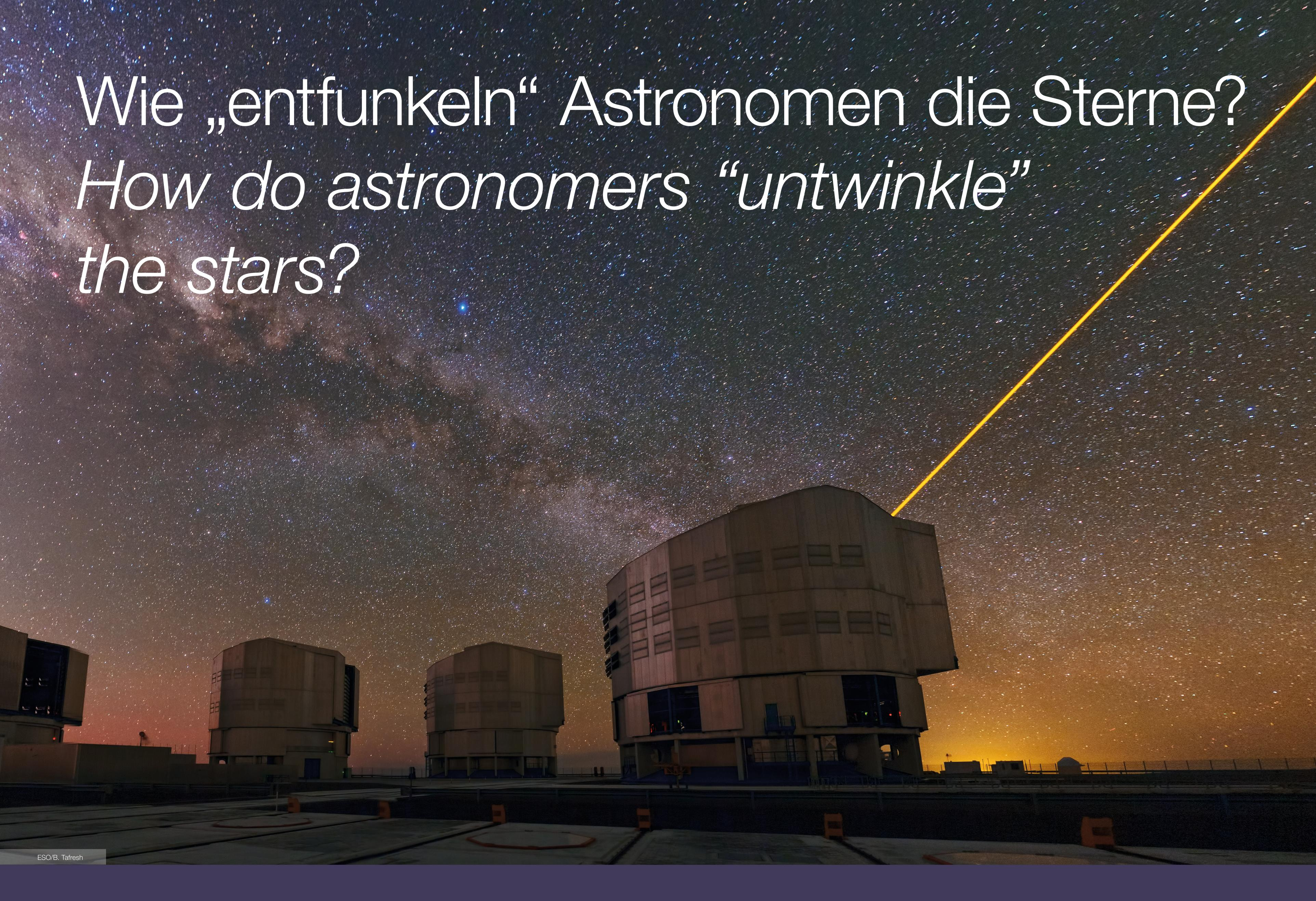
Turbulenzen in der Luft führen dazu, dass das Sternenlicht funkelt. Um diesen Effekt zu entfernen, messen Astronomen die Luftverwirbelungen und korrigieren sie mit verformbaren Spiegeln — eine Technik, die Adaptive Optik genannt wird.
