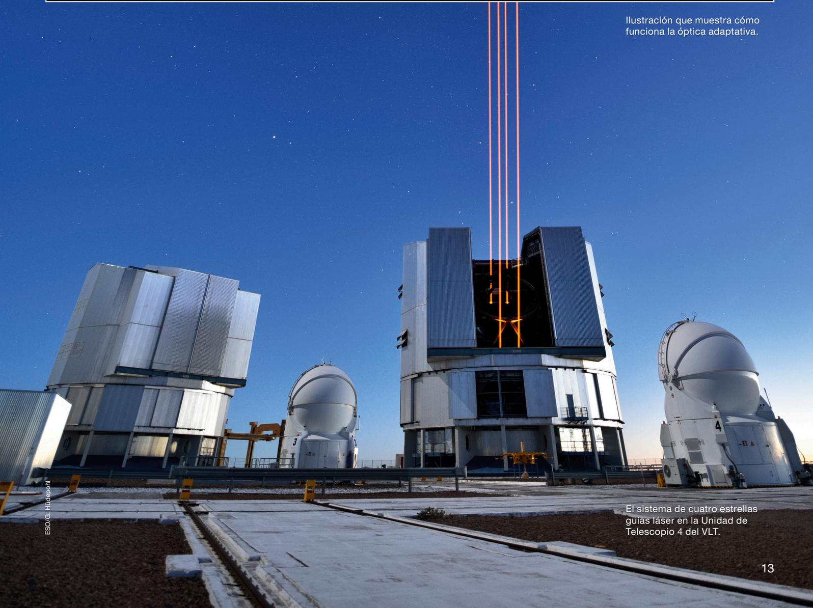
El sistema de cuatro estrellas guías láser en la Unidad de Telescopio 4 del VLT.
