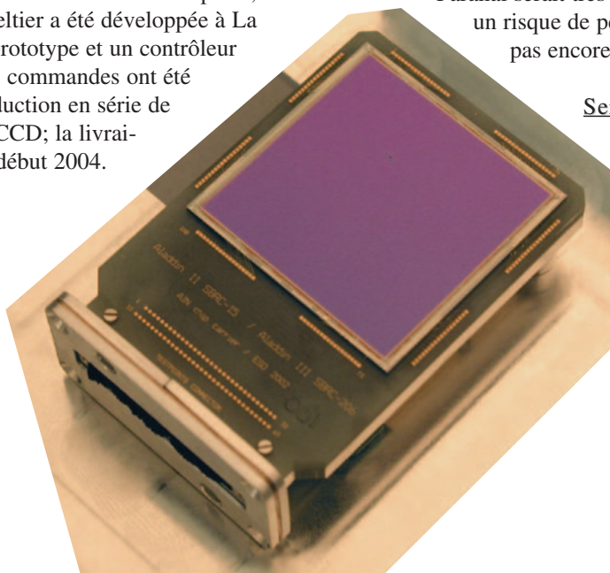
L'une des matrices Aladdin III de CRIRES, montée sur une carte mère en céramique conçue par l'ESO.
